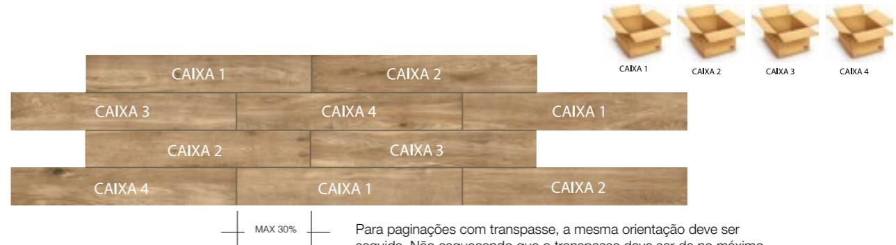
Para paginações com transpasse, a mesma orientação deve ser seguida. Não esquecendo que o transpasse deve ser de no máximo 30% do comprimento da peça.
