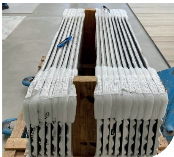
Armazenamento das peças na vertical com o maior lado apoiado sobre estrado de madeira
