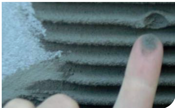
Cordão da argamassa amassado, sujou o dedo: tempo em aberto não vencido
